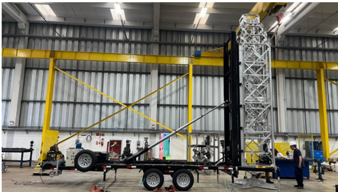
Figura 2 – Torre de emergência móvel cabeça de série basculada em 90°.
