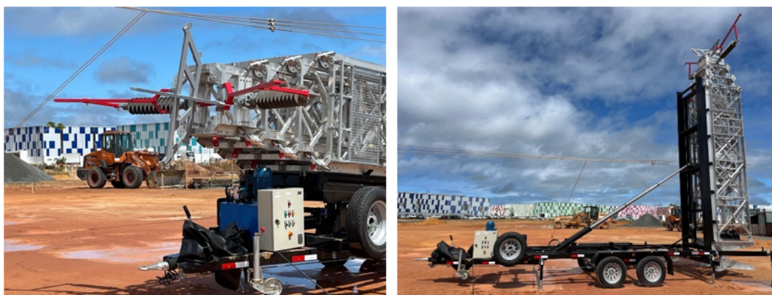
Figura 7 – Torre de Emergência com line posts de 69 kV instalados.
